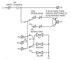
$\underline{1}$ RM7840G: REQUIRES SEPARATE POLE TO CONNECT GAS MV TO TERMINAL 21. J. NO VP/DUAL FUEL: GAS DSI, OIL 10 SECOND MFEP M24127A
