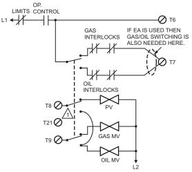
RM7840G: A SEPARATE POLE NEEDED TO CONNECT OIL MV TO /1\ TERMINAL 21. H. NO VP/DUAL FUEL: GAS 10 SECOND MFEP, OIL DSI
