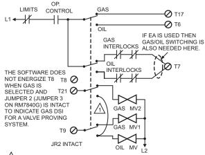
RM7840G: CONNECT OIL VALVE DIRECTLY TO TERMINAL 21 SIDE OF FUEL SWITCH - DO NOT USE THE JUMPER. <u>/1</u> T. VALVE PROVING/DUAL FUEL: DSI FOR GAS AND OIL
